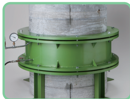
外水圧0.1MPaの水密試験により 漏水がないことを確認しています
